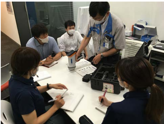
標準サンプルを用いたハンドヘルド型蛍光X線分析計による分析の様子
