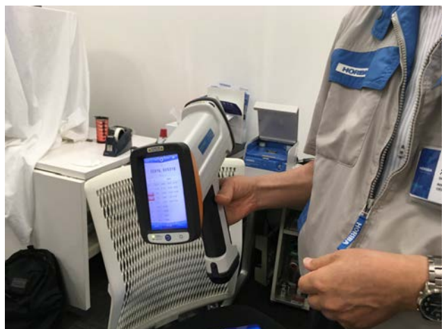
標準サンプルを用いたハンドヘルド型蛍光X線分析計による分析の様子
