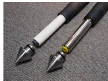
図-3 地下水サンプラーの例
