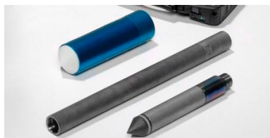
図-1 CPT プローブの例
