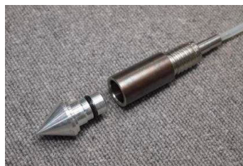
図-2 土壌ガスサンプラーの例
